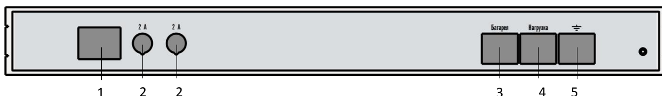
Рисунок 2 – Разъемы на задней панели УЭП 1-1
